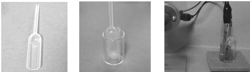
図7 a) ポリスポイトの加工 b) 電解槽に入れた様子 c) 放電中にポリスポイトを差し込む
