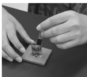
図14 a) 亜鉛板を硫酸銅(II)水溶液につける
